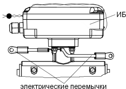
Рис.10. Электрические перемычки на ИБ расходомера.
